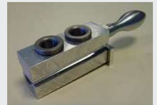
Gabarit de perçage des équerres de maintien GABPC5050EQ
