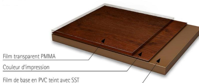
Les films PVC ont deux couches. Les pigments colorés dans le film de base utilisent la technologie de protection solaire. Cela protège le profilé d'une accumulation excessive de chaleur. La couche de base peut rester de couleur unie ou être imprimée, la couche supérieure transparente en PMMA protège les couleurs et les motifs contre le ternissement provoqué par les rayonnements UV et les autres effets des intempéries.
